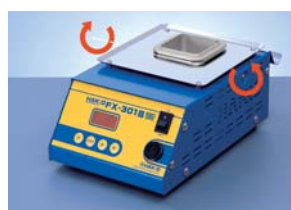
解松熔锡炉两旁的螺丝
