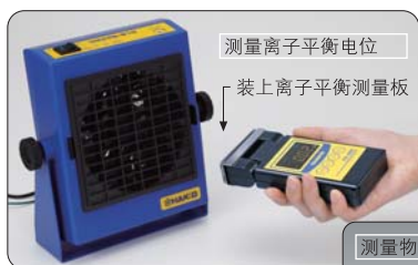
离子平衡测量距离可在1V内
