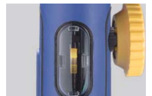
真空吸取指示器，当成功吸起组件后，指示器也会上升，清楚显示作业状态。
