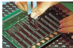
1. 当焊锡从穿孔流出时便可拆除IC。
