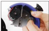
打开上盖(必须先从未机身拔掉转接器插头)
