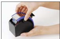
打开上盖(必须先从未机身拔掉转接器插头)
