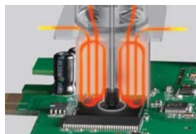
全新设计 BGA 喷咀，热风会在内部产生对流，让喷咀内的温度更平均。
