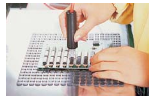
2. 拆除IC后再用气压系统清除残锡。
