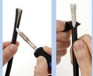
适用于切除较粗电线外皮，方便快捷、轻松流畅。
