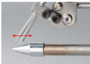
设有V-CUT切割锡线标准装置。切开锡线可以有效防止锡球飞散。使用不同直径锡线时，只须更换滑轮装置，简单容易。
