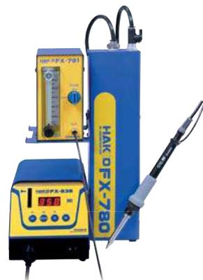
\* 白光FX-838+FX-8302+FX-780+FX-791之氮气系统组合
