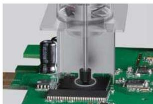
真空吸取功能，只有在焊锡充份熔化后才会吸起组件，避免对焊盘造成损坏。
