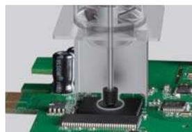
真空吸取功能, 只有在焊锡充份熔化后才会吸起组件, 避免对焊盘造成损坏。
