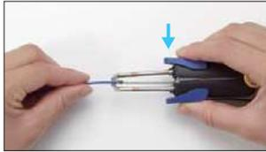
刀具可以打开至 $\Phi 12\text{mm}$ ，能够剥除粗电线外皮。
