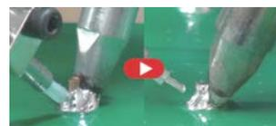
处理需要高热量的焊接时，使用 300W 焊咀可快四倍。
