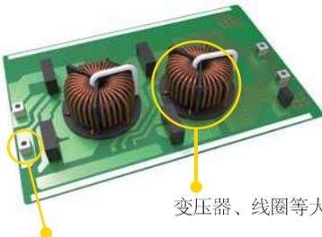
变压器、线圈等大型部件
