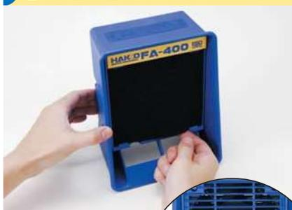
用手指钩住过滤片(图示位置)，再将过滤片拉出。
