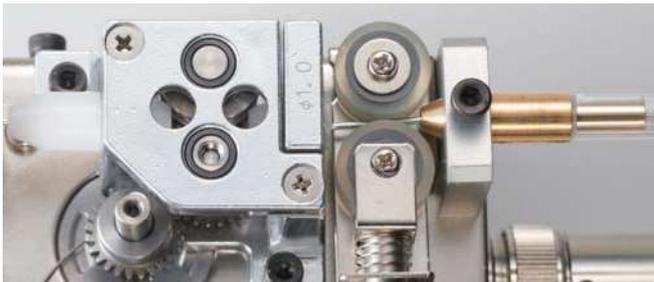
可以对应最小 $\phi 0.3\text{mm}$ 锡线，适合精密的焊接工艺。
