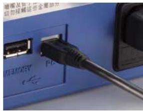
可使用USB连接电脑进行温度实时监测或加热编程。
